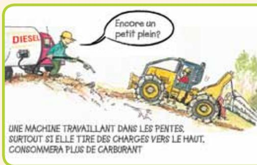
Les conditions d'utilisation sont des facteurs qui influencent la consommation de carburant. Le fait de tirer des charges vers le haut d'une pente, de même que l'enfoncement et le glissement des roues augmentent la consommation de carburant de façon significative dans le cas des débardeurs et des porteurs. De plus, la grosseur des arbres et la résistance à la coupe affectent la consommation de carburant des abatteuses-façonneuses, des abatteuses-groupeuses et des ébrancheuses.
